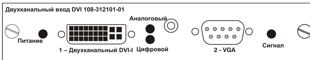
Рисунок 2-3 Подключение аналоговых или цифровых видеоприборов
